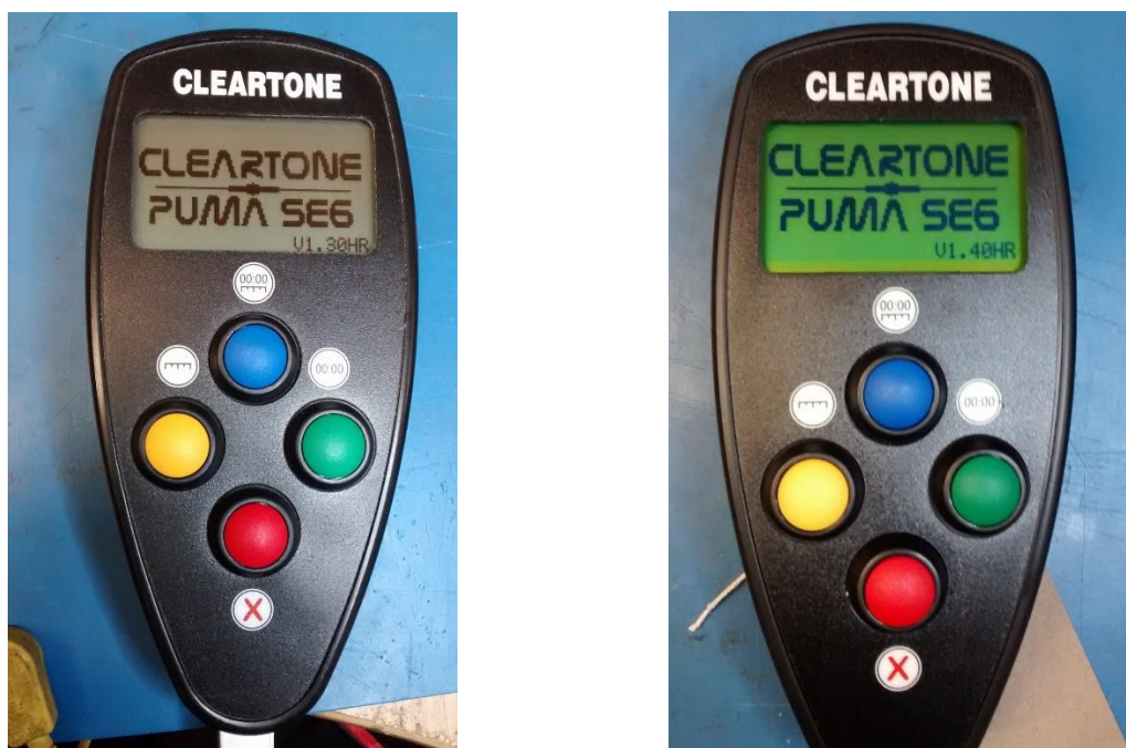
Slika 6. Ručna upravljačka jedinica SE6/1 s prikazom ugrađenog softvera (firmware-a) verzija 1.30HR i verzija 1.40HR
